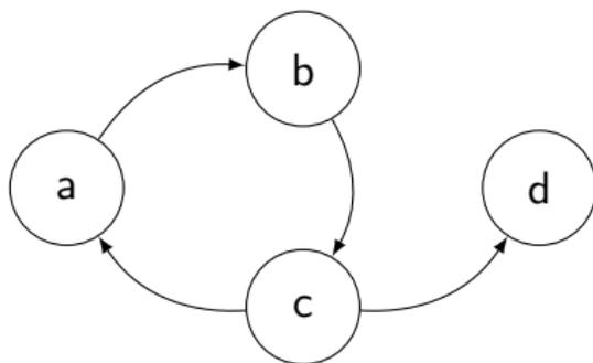
$\text{adj}(a,b).$        $\text{adj}(b,c).$        $\text{adj}(c,a).$        $\text{adj}(c,d).$
