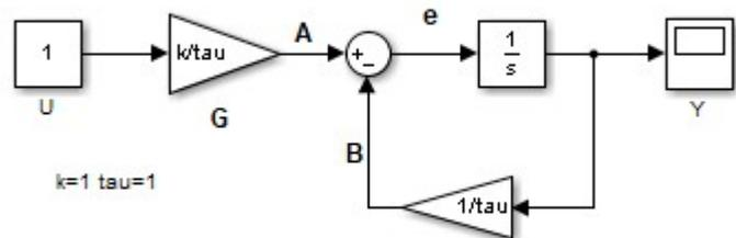
sortie  $Y$ . Avec le même principe, dans le cas de la dérivée par rapport à  $k$ , seul le premier bloc est à modifier. Le reste du modèle augmenté ne change pas !
